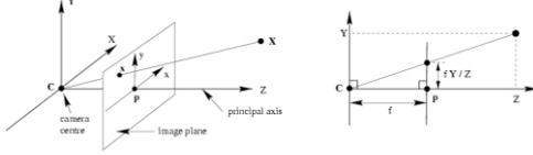
$$\begin{pmatrix} fX \\ fY \\ Z \end{pmatrix} = \begin{bmatrix} f & & 0 \\ & f & 0 \\ & & 1 \end{bmatrix} \begin{pmatrix} X \\ Y \\ Z \\ 1 \end{pmatrix}$$
